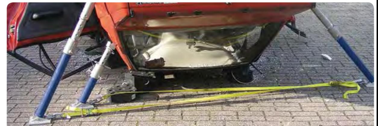
Fahrzeug-Stabilisierung mit ART-Lite-Stütze
