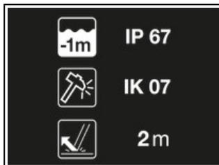
Sie ist staub- und wasserdicht (IP67), stoßfest (IK07) sowie sturzfest bis 2 Meter und passt sich somit allen professionellen Arbeitssituationen an.
