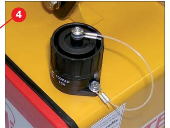
Binder Steckdose für das Teklite Ladegerät um die 12 Volt 12 Ah Batterie aufzuladen
